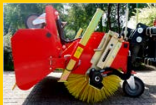
Freikehrmodus, hydraulische Behälterentleerung und drittes Stützrad am Sammelbehälter
