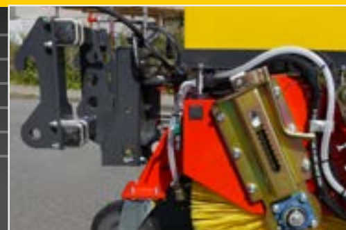
Radladeraufnahme mit Niveausausgleich über Rollenführung
